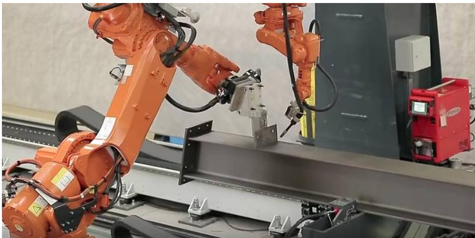
*Figura 13 Célula de Soldadura de vigas ZEMAN*
