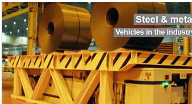
Figura 17 AGV da empresa AGV Group para a indústria da metalomecânica.
