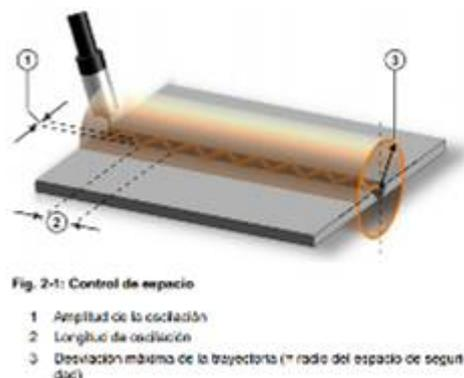
Figura 4. Esquema do sistema de seguimento de junta da KUKA
