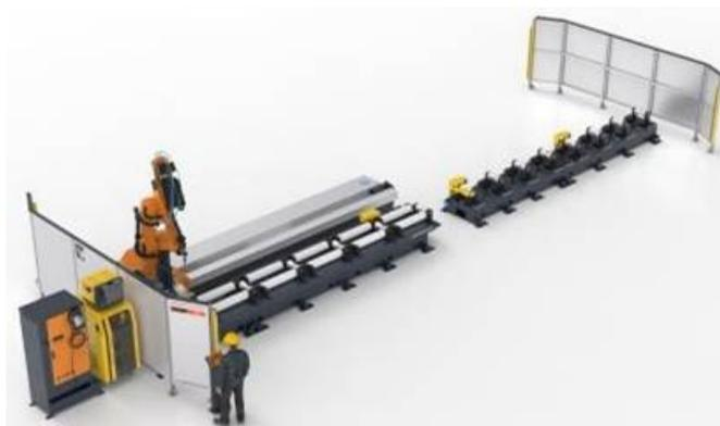
Figura 11. Célula Flexível de corte de tubos por plasma
